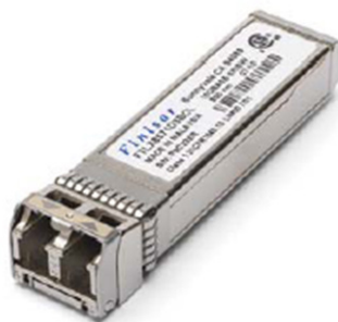
图2-15 万兆 SFP+光模块外观示意图
