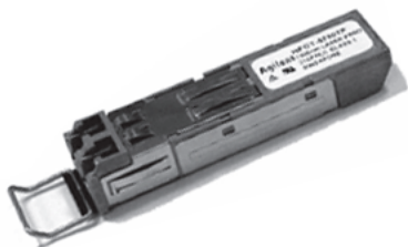
图2-14 千兆 SFP 光模块外观示意图
