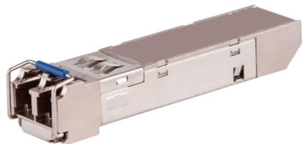
图7-1 2.5G/千兆/622兆/百兆 SFP 光模块外观示意图
