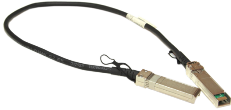
图5-2 SFP+电缆外观示意图
