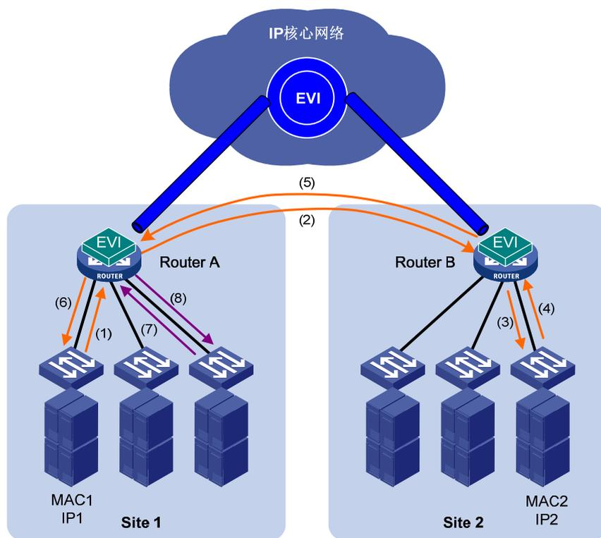
如 图 1-9 所示，ARP泛洪抑制的处理过程如下：
