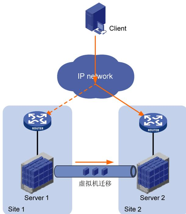
EVI（Ethernet Virtual Interconnect，以太网虚拟化互联）是一种先进的“MAC in IP”技术，是一种基于IP核心网的二层VPN技术。它可以基于现有的服务提供商网络和企业网络，为分散的物理站点提供二层互联功能。EVI只是在站点的边缘设备上维护路由和转发信息，无需改变站点内部和IP核心网的路由和转发信息。
