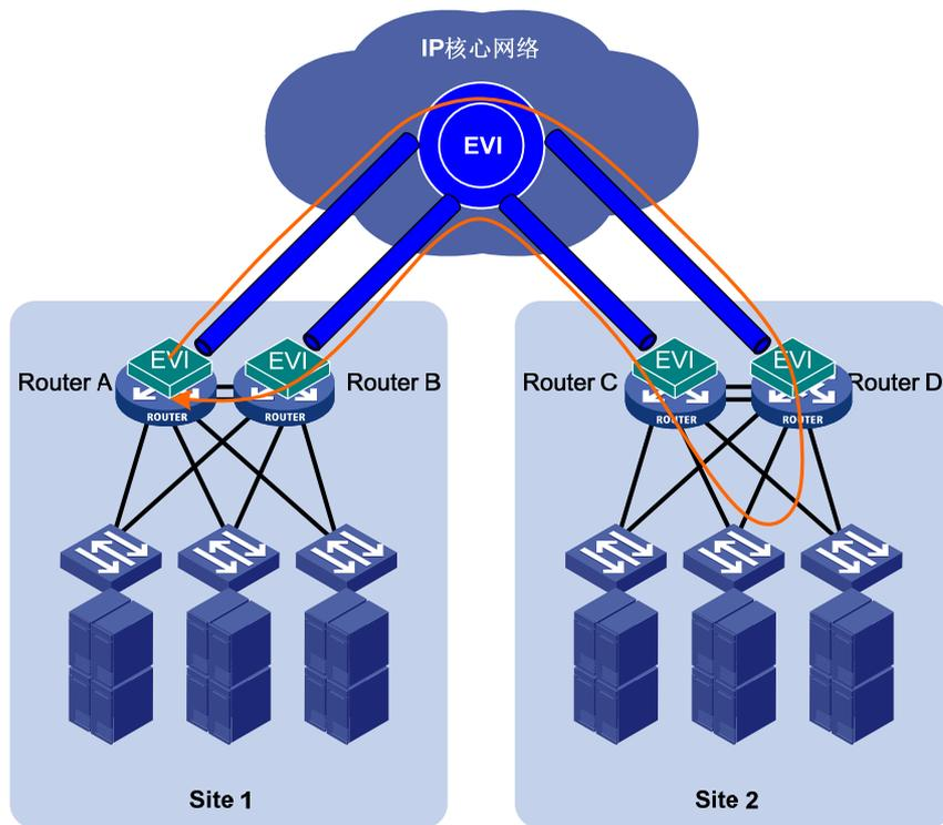
有两种方法来解决站点间的环路，第一种方法是通过IRF技术将物理上的多台设备虚拟化成逻辑上的单台设备，将双归属的边缘设备组成一个IRF，如 [图 1-7](#) 所示。
