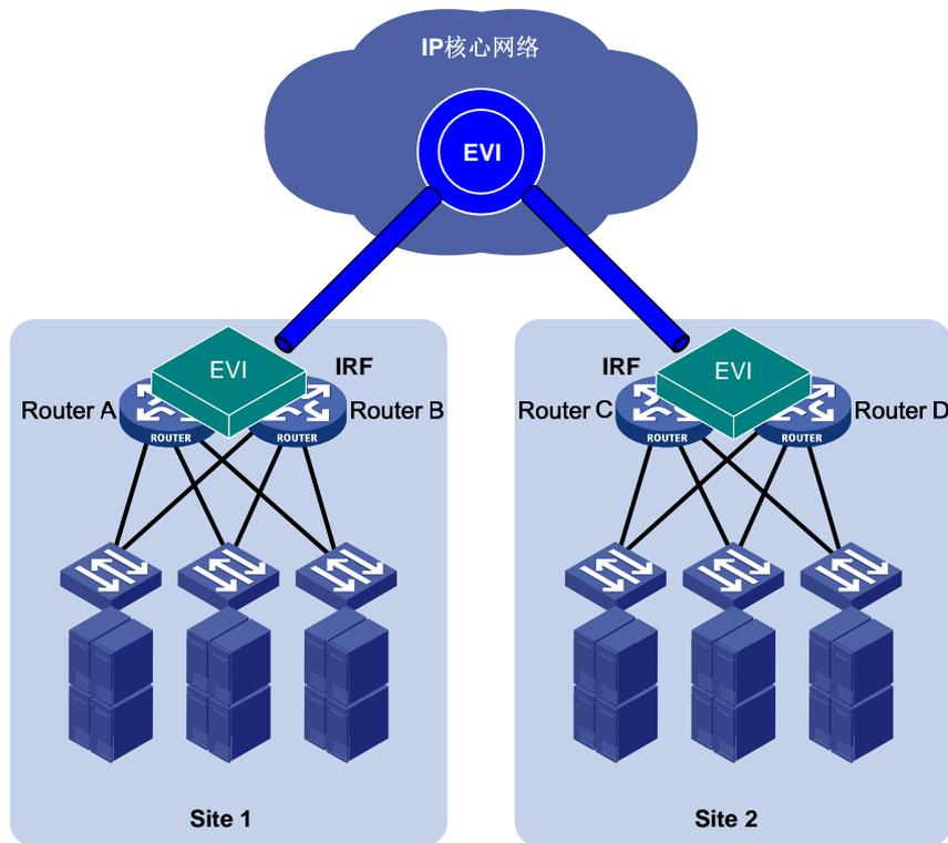
但是，在边缘设备不支持IRF或者在站点融合或者分裂的过程中无法用IRF技术时，必须部署第二种防止环路的方法：使同一个VLAN的流量必须从同一个边缘设备进出核心网，此时该边缘设备称为该VLAN的授权转发设备，该VLAN称为授权转发设备的激活VLAN。如 [图 1-8](#) 所示，VLAN 1000 在Router B和Router D上为激活VLAN，则VLAN 1000 的流量只会在这两个设备之间进出核心网络。
