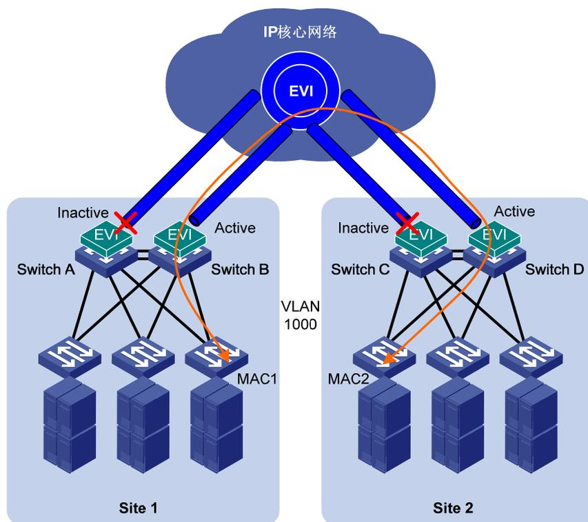
边缘设备在站点内的网络上运行站点内 EVI IS-IS 协议，协商各个边缘设备的激活 VLAN。边缘设备之间通过在站点内交互 EVI IS-IS Hello 报文来形成邻居关系，之后相互通告各自配置的扩展 VLAN，并选举出一个 DED（Designated Edge Device，指定边缘设备），由 DED 为站点内的各个边缘设备分配需要分担的激活 VLAN。双归属负载分担时，DED 会平均分配扩展 VLAN 给两个边缘设备。为了保证同一站点内的两台边缘设备在站点内的可达性，以完成 EVI IS-IS 协议报文交互过程，在规划数据中心网络时要配置指定 VLAN 来承载站点内的 EVI IS-IS Hello 报文。
